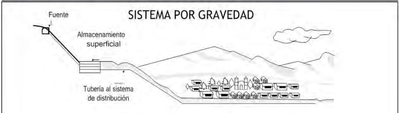
Figura 3.3. Esquema de abasto y distribución de agua
