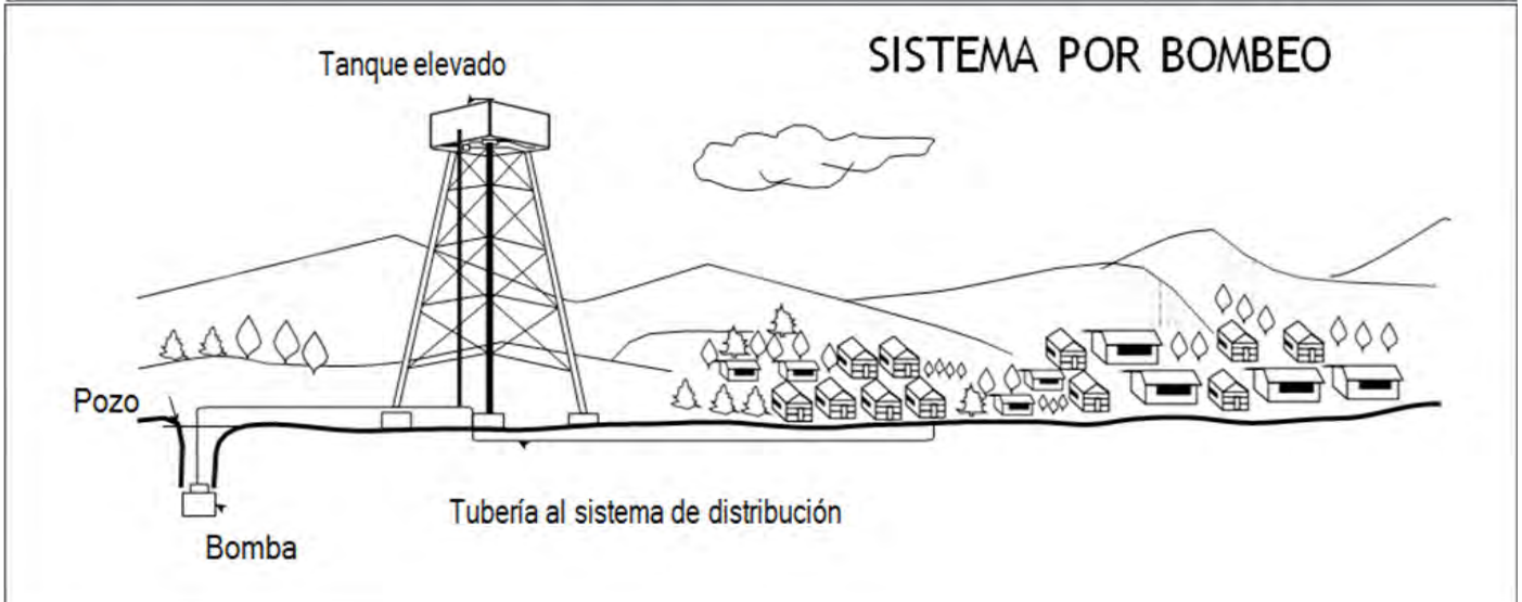
Figura 3.1. Sistema de abastecimiento de agua con fuente subterránea
